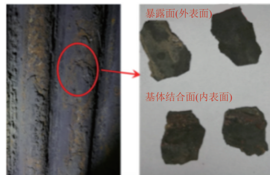
图2 锅炉水冷壁腐蚀剥落物形貌
